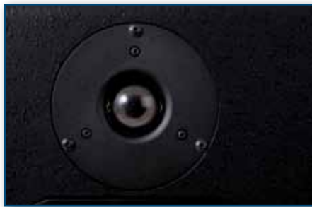
Der Hochtöner hat eine vergleichsweise große 28-Millimeter-Gewebe-Kalotte und kommt – typisch für Quested – ohne Waveguide aus.
