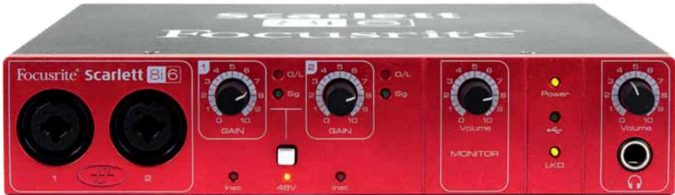
Die Frontplatte des Scarlett 8i6 zeigt sich schnörkellos ausgestattet. So finden sich Potis zum Einstellen der Eingangsverstärkung, zur Lautstärke-Kontrolle von Monitor- und Kopfhörer-Ausgang sowie ein Taster zum Aktivieren der Phantomspannung.
