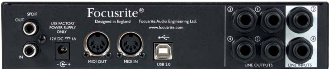
Zusammen mit den frontseitigen Combo-Buchsen offeriert das Scarlett USB-Interface insgesamt je vier analoge Ein- und Ausgänge. Hinzu gesellen sich eine S/PDIF- und MIDI-Schnittstelle.
