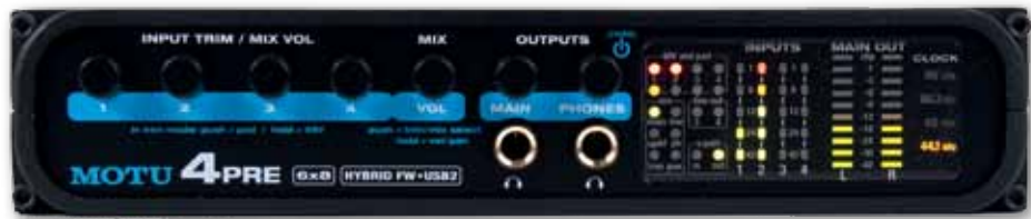
Die Multifunktions-Endlosdrehregler steuern nicht nur digital die Eingangsverstärkung der analogen Preamps, sondern ermöglichen die komplette Bedienung (auch Stand-alone) ohne zusätzliche Buttons, beispielsweise das Aktivieren von Pads oder der Phantomspeisung.
