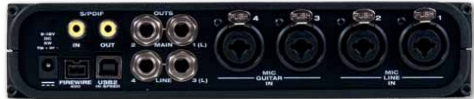
Das 4pre ist mit einer USB2- und Firewire-Schnittstelle ausgestattet. Beim USB-Einsatz ist das zusätzliche Netzteil jedoch erforderlich.
