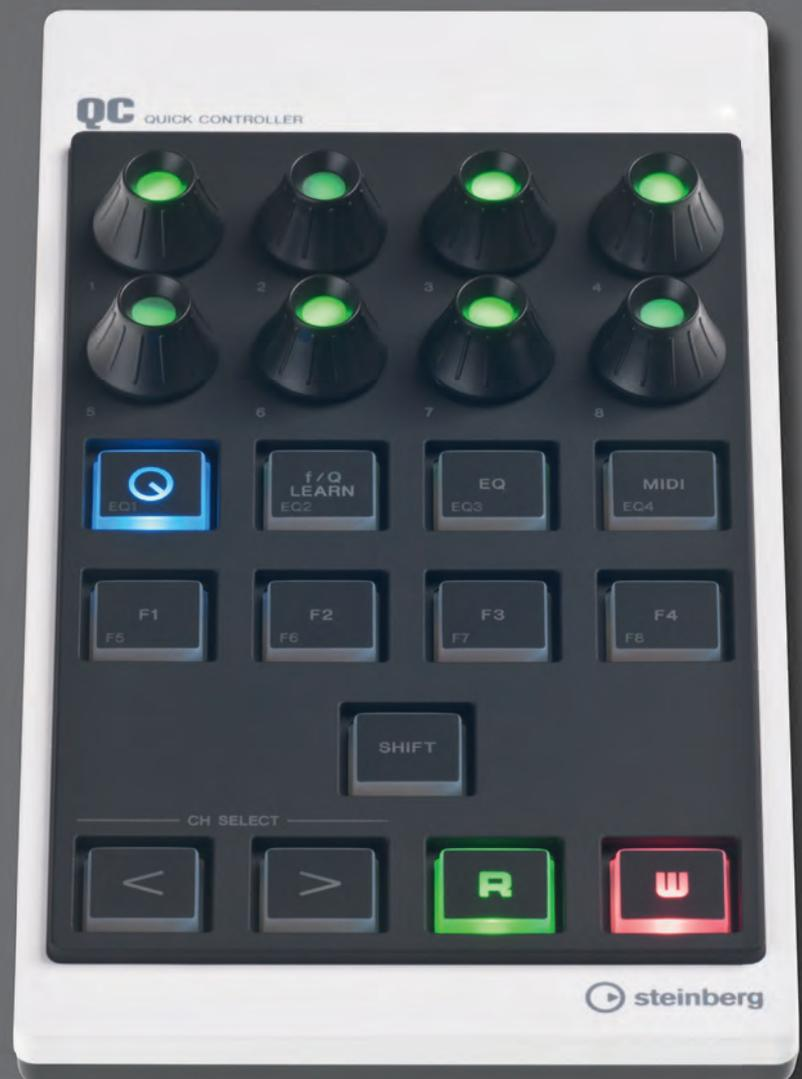
Der QC-Controller verfügt über drei Betriebs-Modi und erlaubt das Editieren der Quick-Control-Sektion, des Kanal-Editor-EQs sowie frei wählbarer MIDI-Controller.
