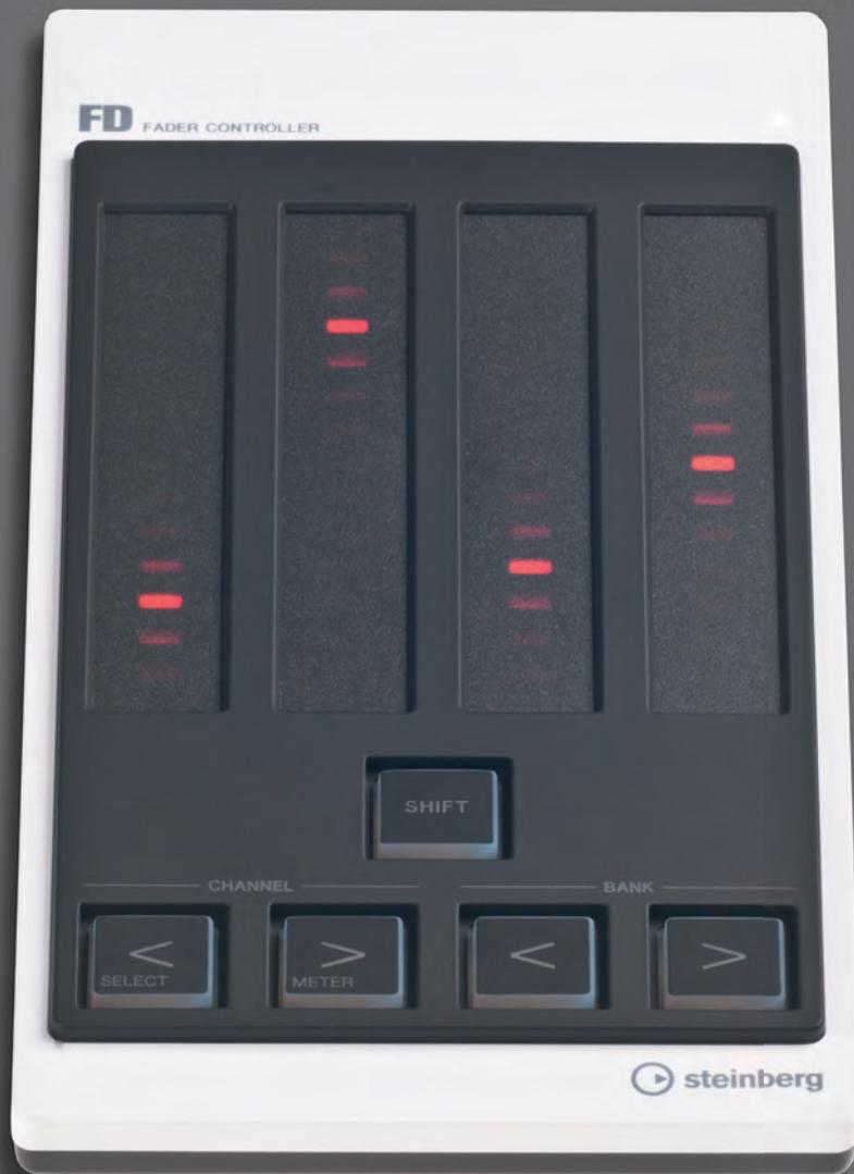
Das Einstellen der vier Kanalfader im CMC-FD-Controller wird mit Hilfe von Touch-Pads realisiert, die über eingelassene LEDs Auskunft über ihre Position abgeben.
