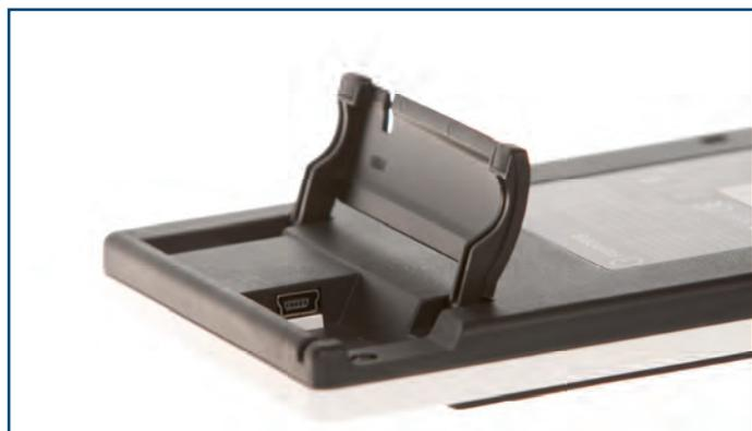
Die Verbindung der Controller zum Rechner erfolgt über USB, wobei sich der Anschluss auf der Unterseite erst nach Aufklappen des Standfußes zeigt.
