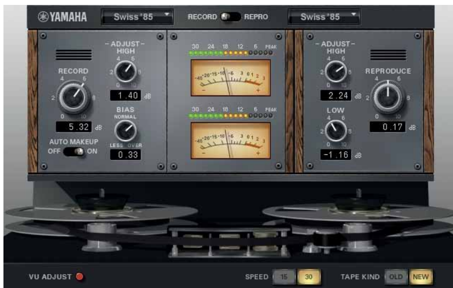
Das Vintage Open Deck Plug-in emuliert den Sound der Aufnahme- und Wiedergabe-Sektion von vier klassischen Bandmaschinen. Zusätzlich lässt sich die Bandsorte und Laufgeschwindigkeit ändern.
