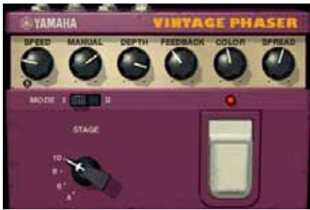
Der Vintage Phaser eifert keinem besonderen Vorbild nach. Per Mode-Schalter stehen zwei Klangcharakteristika zur Auswahl, die ihrerseits in der Anzahl der Filterkämme (Stages) einstellbar sind.
