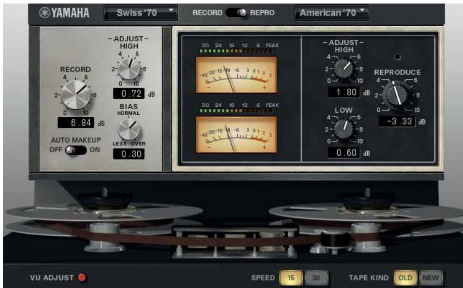
Wer mag kann in Frankenstein-Art die Studer- und Ampex-Emulationen in der Aufnahme- und Wiedergabe-Sektion frei miteinander kombinieren, was die Optionen zur Klanggestaltung noch einmal erweitert. Die VU-Meter zeigen per Kippschalter wahlweise die Pegel von Aufnahme- und Wiedergabe-Sektion an.
