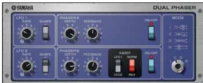
Der Dual Phaser besitzt gleich zwei Phaser-Sektionen nebst eigenem LFO, die sich per Mode-Schalter auf verschiedene Weise parallel oder seriell verschalten lassen.
