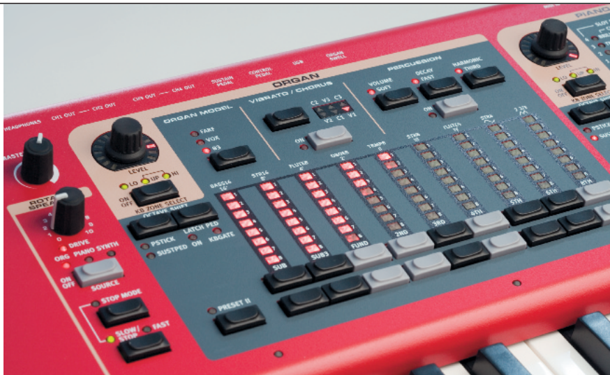
Auf die Nord-typische „Zugriegelbedienung“ via Buttons und LED-Ketten reagiert jetzt eine Tonewheel-Simulation à la CZ.
