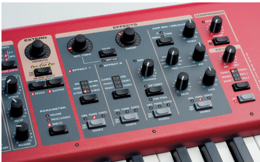
Der Synthesizer im Stage 2 kann auch Samples als Oszillatoren verarbeiten. Zudem sorgt in dieser Sektion ein Arpeggiator für Abwechslung.
