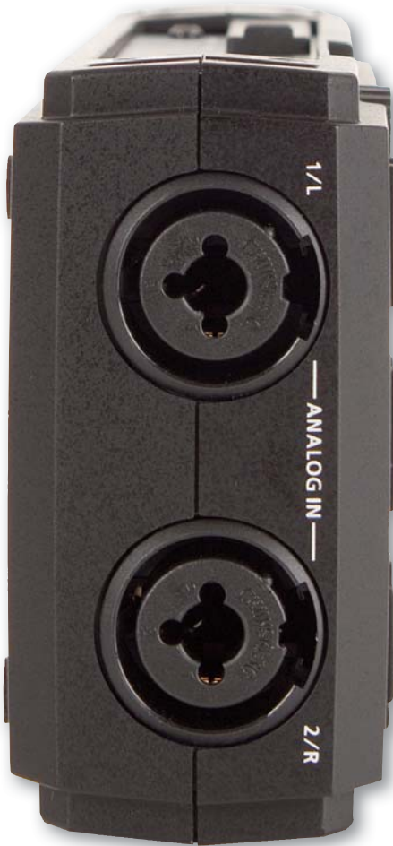
▲ Mit zwei XLR/Combo-Buchsen ausgestattet, können sowohl externe Mikrofone als auch Geräte und Instrumente mit Line-Pegel angeschlossen werden. Phantomspannung für Kondensatormikrofone gibt es auch.
