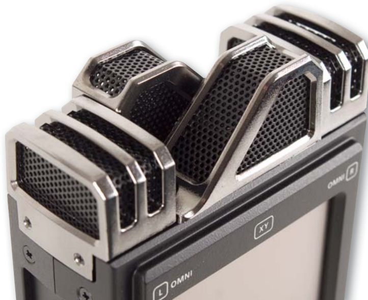
Vier Kapseln hat der R-26 zu bieten. Zwei (Niere) sind in X/Y-Anordnung installiert, die anderen beiden (Kugel) decken einen weiten, omnidirektionalen Aufnahmebereich ab.
