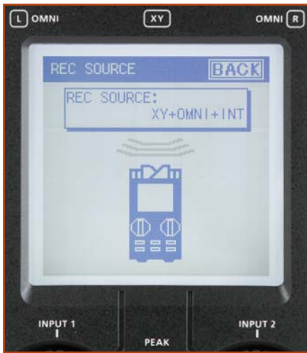
XY+OMNI+INT bedeutet: Drei Stereospuren werden gleichzeitig aufgenommen, wobei die Erste das X/Y-, die Zweite das Omni- und die Dritte eine Mischung aus beiden beinhaltet.
