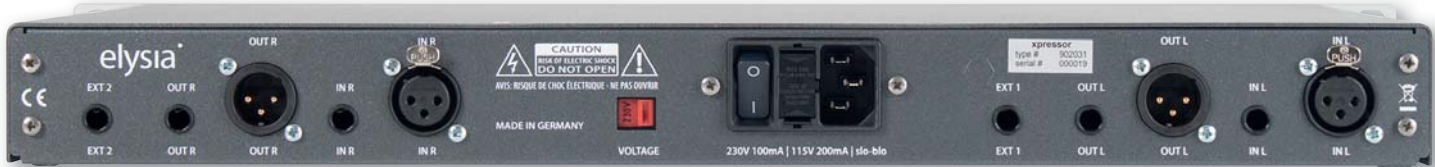
Anders als die API500-Variante verfügt der 19-Zoll Xpressor über XLR- und Klinkenbuchsen für Ein- und Ausgang. Überdies besitzt er auch einen externen Sidechain, wobei der Anschluss EXT1 als Return und EXT2 als Send fungiert.
