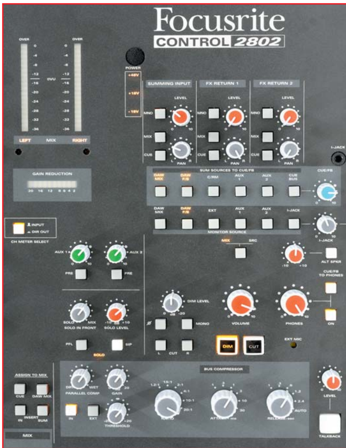
Highlights in der Master-Sektion sind der exzellent klingende Bus-Kompressor sowie die Möglichkeit additiv mehrere Signale auf den Cue-Bus und den Monitor-Out zu schicken. Über die Assign to Mix-Buttons können verschiedene Signale und Busse auf den Mix-Bus summiert werden.
