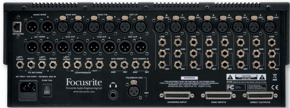
Anschlüsse satt: Über die drei Sub-D-Anschlüsse sowie weitere XLR-Eingänge wie etwa DAW-Mix und DAW-Foldback lassen sich insgesamt bis zu 32 Kanäle ins Pult führen und erlaubt die Aufgabe eines analogen Summierers auszuführen. Die DAW-Controller-Daten werden über die Ethernet-Buchse übertragen.
