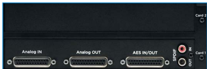
Das Testgerät ist mit dem 8 Analog I/O + 8 AES I/O-Modul ausgestattet. ▼
