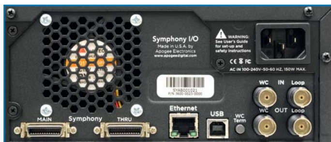
▲ Über die USB-Schnittstelle lässt sich das Gerät entweder als USB Audio-Interface an einem Mac betreiben oder einfach fernsteuern. Der „Main“-Port (links) dient zum Anschluss an eine Symphony 64 oder Symphony Mobile-Karte sowie der Direktverbindung mit Pro Tools HD-Karten.
