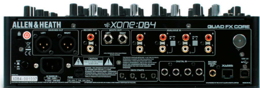
Die Rückseite beherbergt Anschlussmöglichkeiten für je vier analoge und digitale Zuspeler – das USB-Interface nicht zu vergessen.
