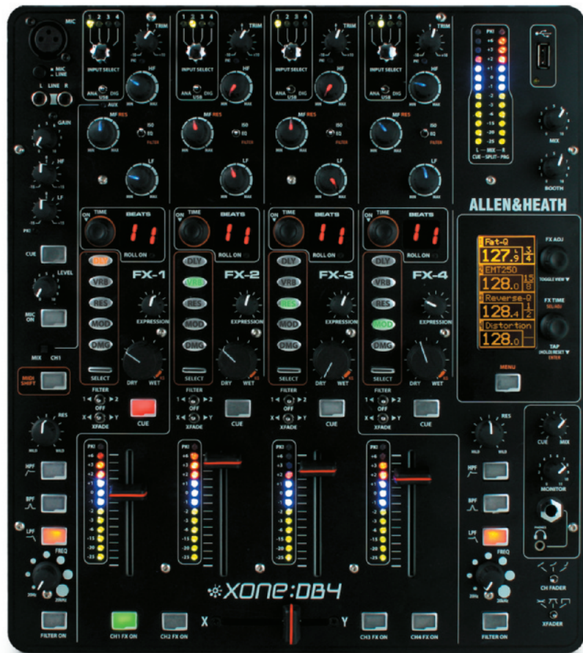
Ein gerastertes Poti und ein Kippschalter ganz oben in jedem Kanal dienen zur Anwahl der Zuspeler: Je vier Quellen können analog, digital oder per USB in den Kanal gespeist werden.
