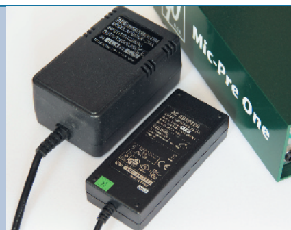
In Deutschland wird der Daking Mic-Pre One mit einem linearen Netzteil ausgeliefert, da das amerikanische Schalt-Netzteil Einstreuungen produzierte.
