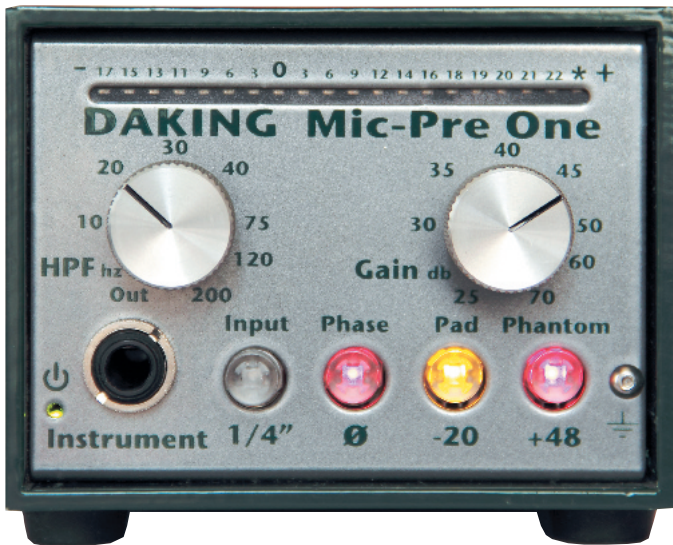
Das Bedienfeld bietet alle Grundfunktionen sowie einen variablen Low-Cut.
