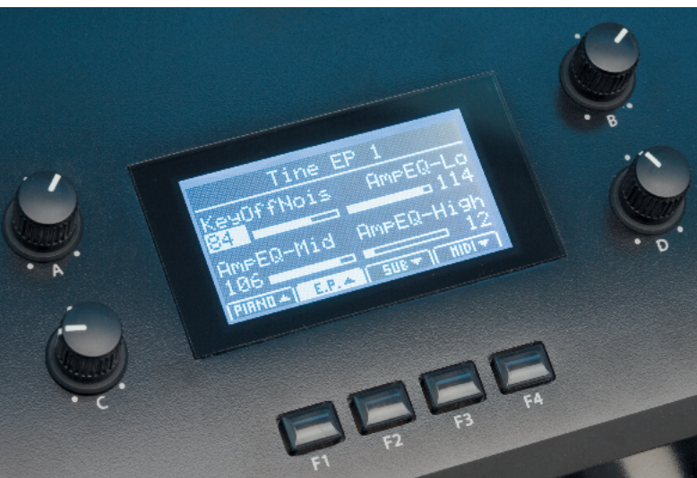
Über die vier Funktionstaster unter dem Display lassen sich vier Drehregler den Sektionen gezielt für die Echtzeitkontrolle von Klangparametern zuweisen.
