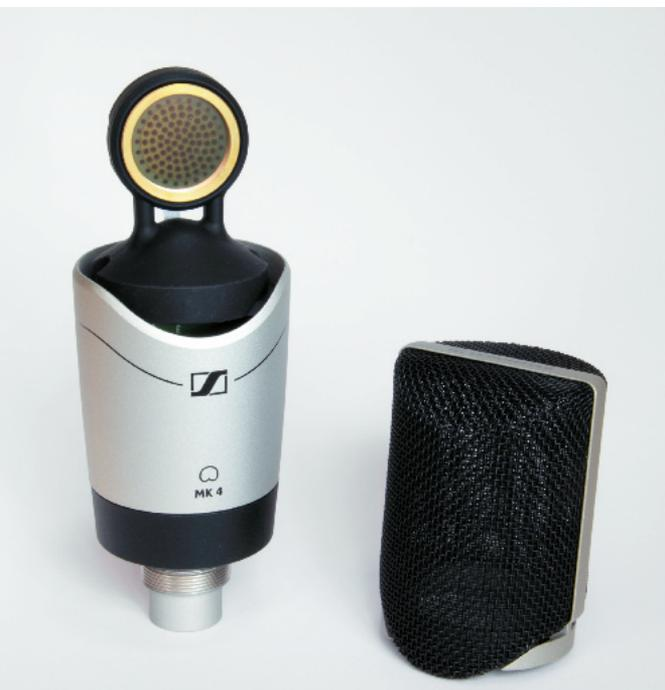
Das Sennheiser MK 4 arbeitet mit einer modernen randpolarisierten Einzelmembran-Echtkondensatorkapsel, die schwingungsdämpfend in Gummi gelagert ist.
