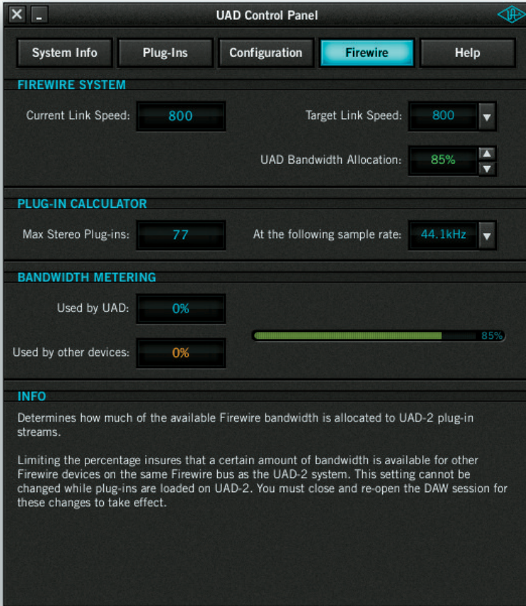
Das Control-Panel zeigt die Auslastung des FireWire-Busses und die mögliche Anzahl an Stereo-Plug-ins.
