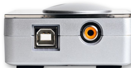
▲ Neben dem USB-Anschluss hat die VRM Box auch einen S/PDIF-Eingang zur Verbindung mit dem Haupt-Audio-Interface.
