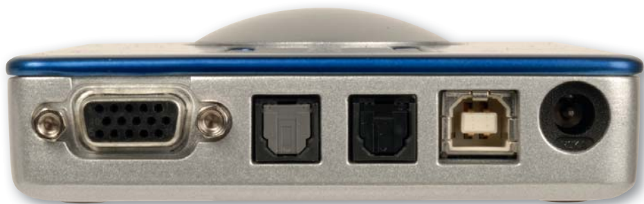
▲ Über die 15-polige Buchse lässt sich, ähnlich wie bei den Hammerfall-Karten, eine Kabelpeitsche anschließen, die je zwei analoge Ein- und Ausgänge sowie MIDI und einen Kopfhörer-Anschluss besitzt.
