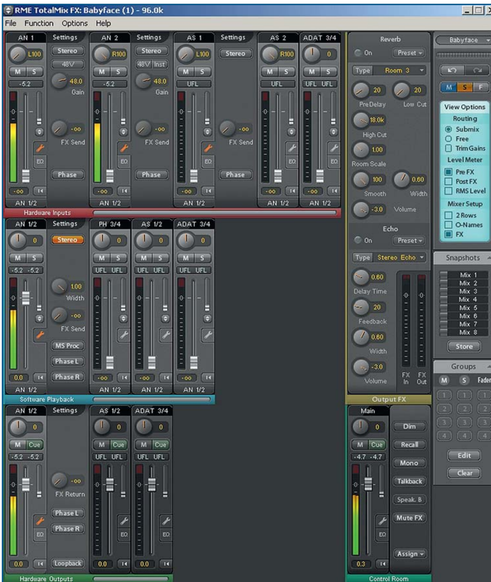
Ebenso wie das Flaggschiff Fireface UFX, lässt sich auch das Babyface über die neue Total Mix FX Software steuern. Besonderheit: Über den integrierten FPGA wird in jedem Kanal ein Equalizer sowie Echo und Hall als Send-Effekt berechnet.
