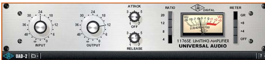
Er darf nicht fehlen: Der legendäre FET-Kompressor 1176LN, hier in der Stereo-Ausführung, eines von Universal Audios Markenzeichen-Produkten.
