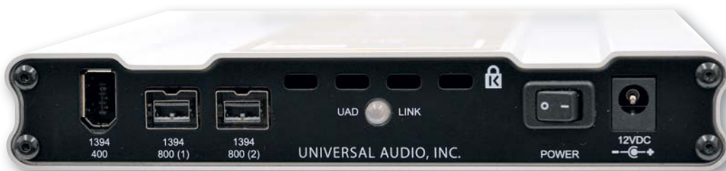
Das Satellite gestattet dank zusätzlicher Firewire 800 und Firewire 400-Schnittstellen den Anschluss eines Firewire-Interfaces. „Bus Powered“-Interfaces benötigen allerdings ein Zusatzgerät für die Stromversorgung.
