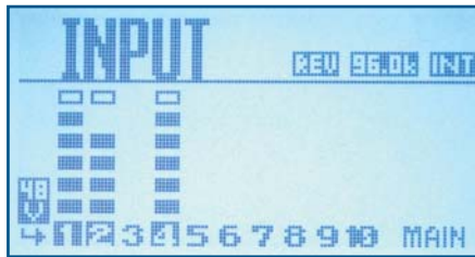
Zur Überwachung der Eingangspegel muss auf das LCD zurückgegriffen werden. Die dunkel hinterlegten Kanalzahlen signalisieren, dass die Phantomspannung aktiviert ist.
