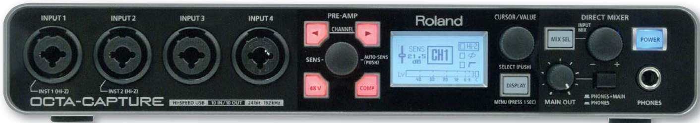
Die ersten beiden Combo-Buchsen (Kanal 1/2) bieten im Hi-Z-Modus auch die Möglichkeit, E-Gitarren und -Bässe anzuschließen. Als eigentümliche aber sehr wirksame Clip-Anzeige dienen die bei Übersteuerung blinkenden Channel-Auswahl-Taster.
