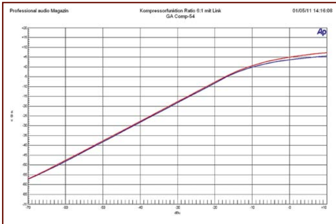
Die Kompressionskennlinie zeigt bildhaft eine Soft-Knee-Charakteristik, die in größter Ratio-Einstellung den Pegel sehr weich reduziert. Die Kennlinien von zwei verlinkten Geräten weichen nur minimal um etwa 0,5 Dezibel voneinander ab.
