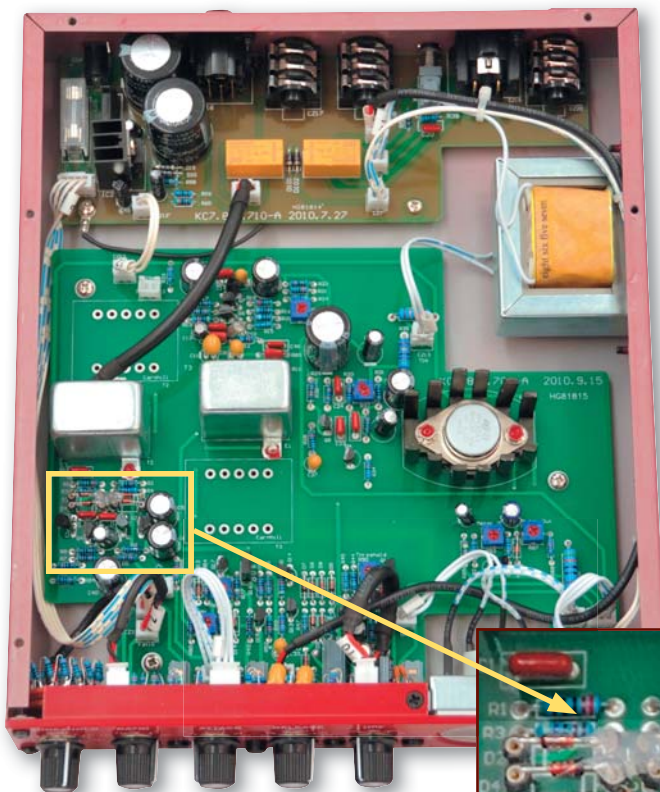
Des Pudels Kern: Wie in der Vorlage erledigt auch im COMP-54 ein Brückengleichrichter die Reduktion der Dynamik (siehe Ausschnittvergrößerung). Darüber finden sich die Ein- und Ausgangsübertrager aus chinesischer Fertigung, die auf Wunsch gegen Carnhill-Modelle austauschbar sind.
