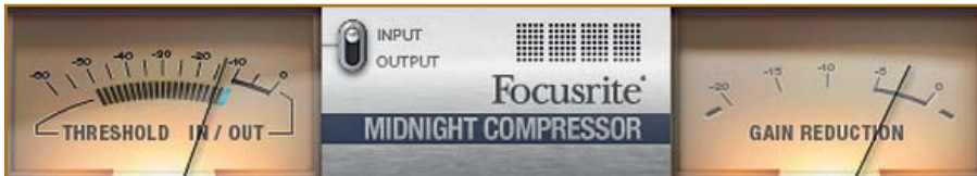
Nicht alltäglich: Die beiden großen VU Meter des Midnight-Compressors geben dem Anwender Auskunft über die Pegelreduktion, anliegende Pegel hinter dem Input-Gain und Blend-Regler sowie über das eingestellte Threshold-Level.
