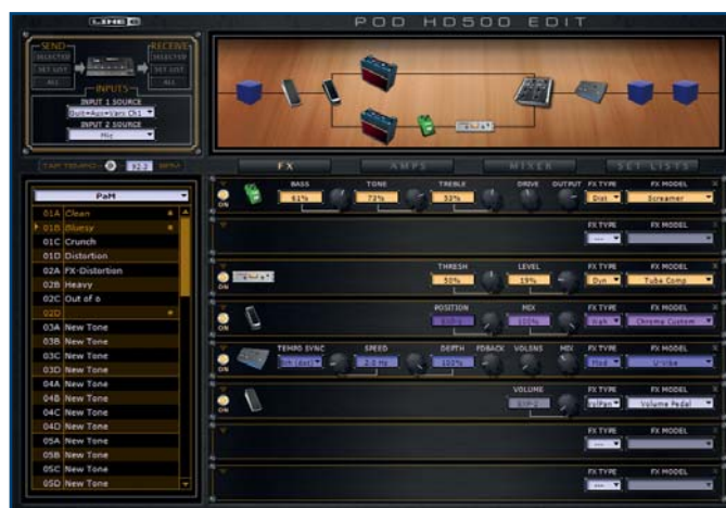
Über 100 Effekte lassen sich den insgesamt acht Slots (FS-Taster 1-8) im FX-Fenster zuweisen. Die realistische Darstellung der Signalkette hilft komfortabel den Überblick zu behalten.
