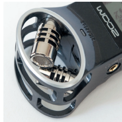
Die Mikrofon­kapseln haben Nieren­charakteristik und sind in einer korrekten XY-Anordnung hinter einem Schutz­bügel montiert.
