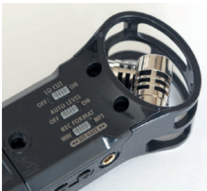
Nix Menüsteuerung: Wichtige Funktionen sind auf der Unterseite per Schieb­schalter verfügbar.
