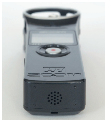
Ein kleiner Kontroll­lautsprecher ist am hinteren Ende eingebaut.
