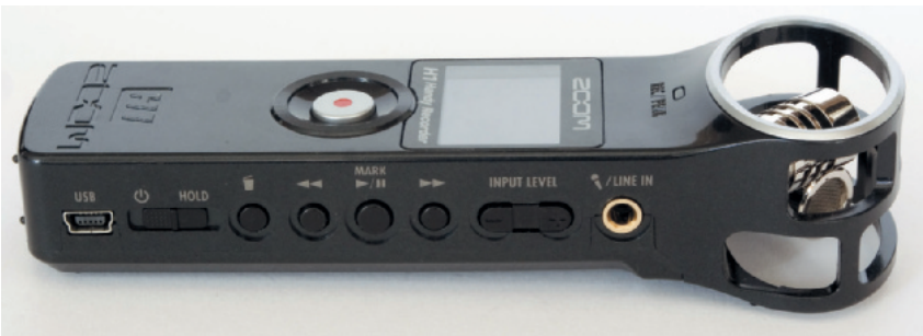
Einem Großteil der Tasten hat Zoom auf die rechte Gehäuseflanke verbannt.
