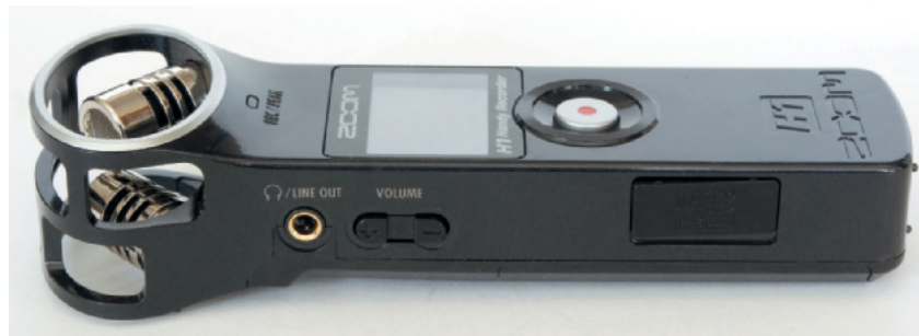
Der Kopfhörerausgang ist über Tiptasten regelbar. Als Aufnahme­medium dienen MicroSD-Karten.
