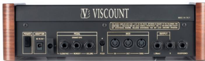
Das rückwärtige Anschlussfeld des DB-3-Moduls
