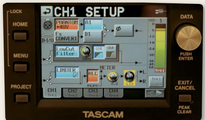
Das Channel-Setup-Menü skizziert einen Channelstrip und bietet von der Phantomspeisung (oben links) bis zur Track-Beschriftung (unten rechts) direkten Zugriff auf alle wichtigen Parameter.
