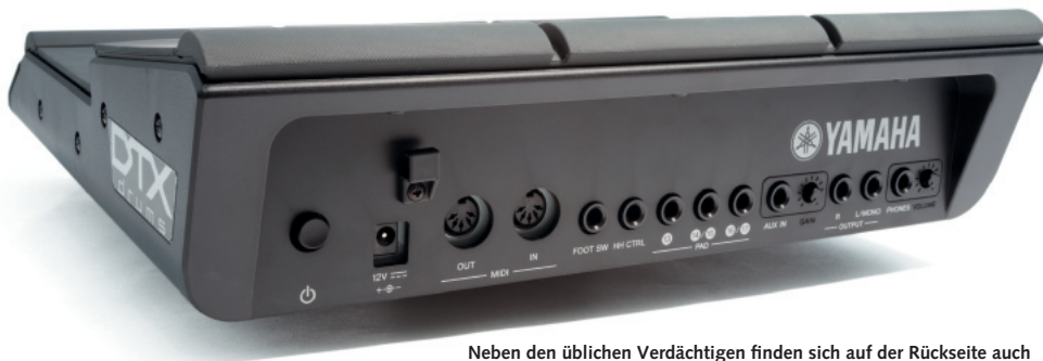
Neben den üblichen Verdächtigen finden sich auf der Rückseite auch insgesamt fünf Trigger-Eingänge, an welche man zusätzliche Pads, einen Fußtaster und ein Hi-Hat-Kontrollpedal anschließen kann.
