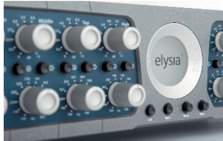
In der Mitte der Frontplatte unter dem Logo befinden sich die Schalter für den Bypass und die Aktivierung der „Warm“-Funktion.
