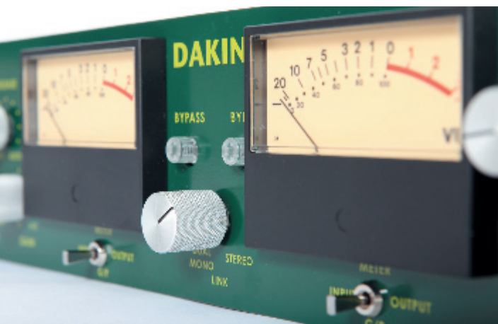
Mit dem Link-Poti zwischen den VU-Metern lassen sich beide Kanäle stufenlos verkoppeln.
