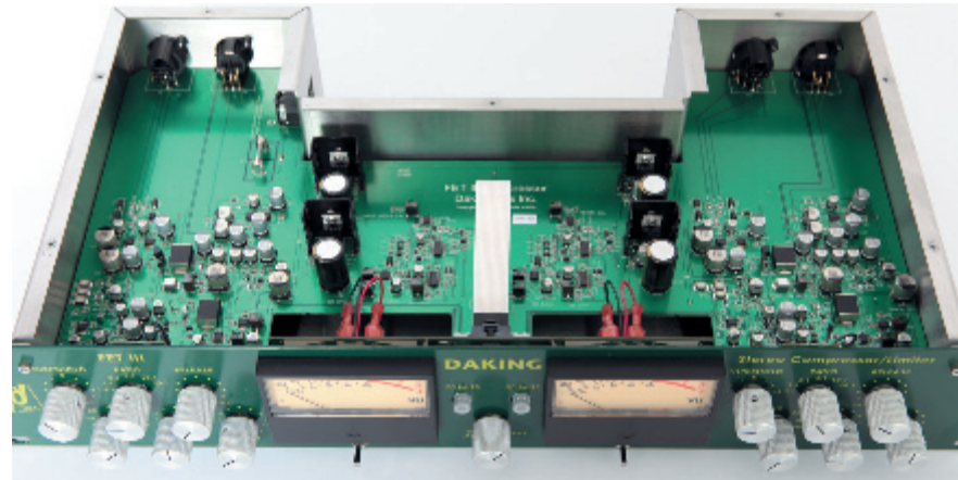
Sämtliche Bauteile finden Platz auf der H-förmigen Hauptplatine.
