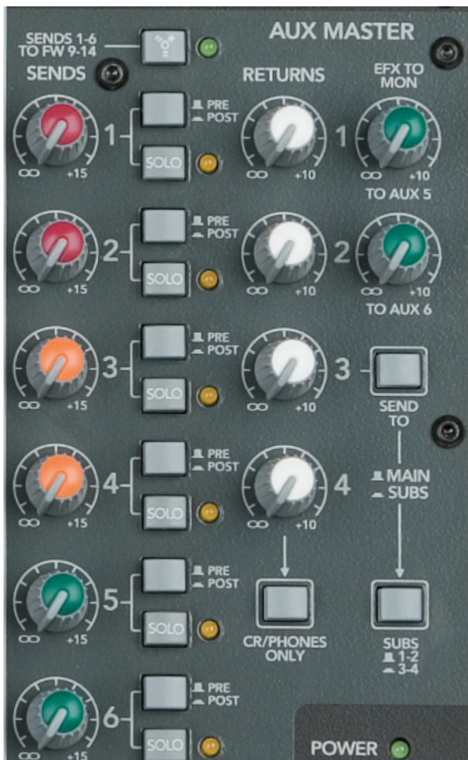
Die Aux-Master-Sektion mit sechs Sends>Returns sowie diversen Routing-Optionen
