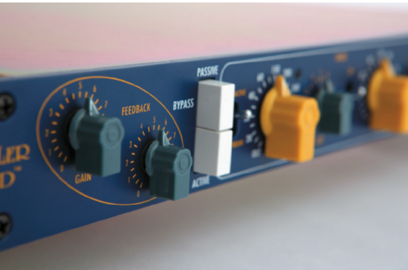
Variables Gain-Staging: Die Feedback-Sektion erlaubt eine breite Palette Klanglicher Variationen.
