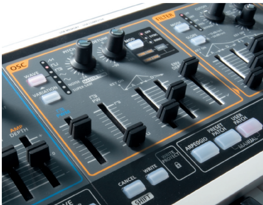
Die Bedienelemente sind übersichtlich nach Funktionsgruppen angeordnet: Es gibt insgesamt 11 Potis und 18 Fader, die sich angenehm cremig fahren lassen. Hier die Oszillator-Sektion.
