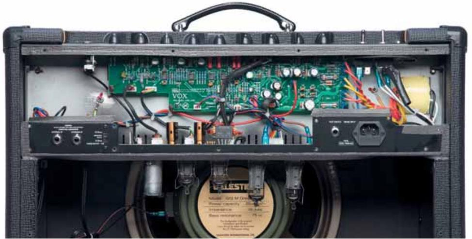
beim AC15C1 die goldfarbene Beschriftung direkt auf das schwarz lackierte Chassis aufgebracht. Ferner hat der AC15C1 ein kurzes Hallsystem, er muss außerdem auf den Reverb-Tone-Regler und das zweite Paar Inputs verzichten (Der AC30C2 hat je Kanal Low und High).
