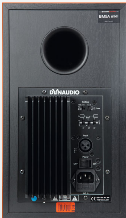
▲ Die Bassreflex-Öffnung auf der Rückseite (oberes Drittel) erfordert bei wandnaher Aufstellung die Aktivierung des LF-Shelvingfilters.
