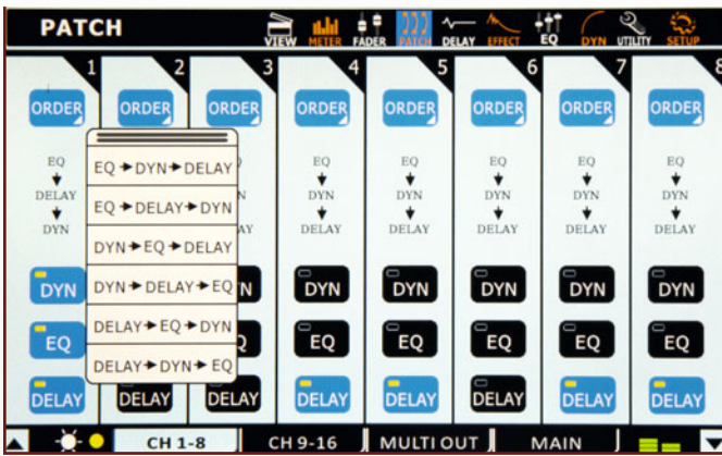
Ein Vorteil der Digitaltechnik: Die Reihenfolge der Kanalzug-Effekte lässt sich auf Fingerdruck in sechs Varianten einstellen.
