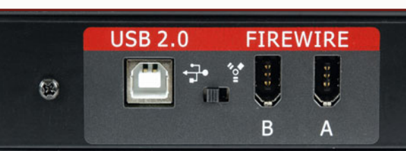
▲ Mit der optionalen Expansioncard wird das Summit zum Audio-Interface im Verbund mit Apple-Rechnern und PCs. Das Summit unterstützt – eine Phonic-Spezialität – sowohl USB 2.0 als auch Firewire 400. Über die zweite Firewire-Buchse lassen sich zwei Pulte kaskadieren.
