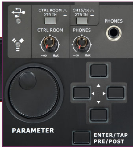
▲ Mit der optionalen Expansioncard wird das Summit zum Audio-Interface im Verbund mit Apple-Rechnern und PCs. Das Summit unterstützt – eine Phonic-Spezialität – sowohl USB 2.0 als auch Firewire 400. Über die zweite Firewire-Buchse lassen sich zwei Pulte kaskadieren.
