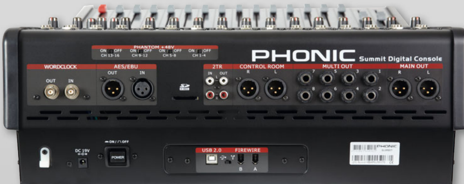
Neben den XLR- und Klinkeneingängen der Kanalzüge, bietet das Pult noch die acht alternativen Ausgänge „Multi-Out“ (rechts im Bild) an, die wahlweise mit den Signalen der acht Aux-Wegen oder der acht Gruppen belegbar sind.
