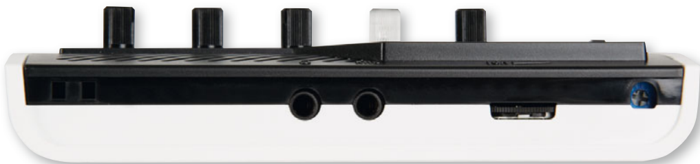
Auf der oberen Schmalseite des Monotron findet sich ein Rädchen zum Regulieren der Lautstärke sowie zwei Mini-Klinkenbuchsen, die den Klang ausgeben und das Einspeisen externer Signale ins Filter ermöglichen. Mit der kleinen Schraube (ganz rechts) lässt sich der spielbare Tonumfang einstellen.
