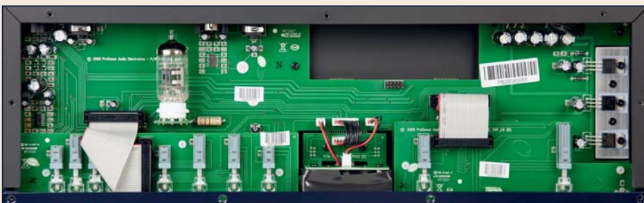
Bei der verwendeten Röhre des Studio Channels handelt es sich um eine Doppeltriode (ECC83/12AX7), über deren genaue Herkunft sich der Hersteller ausschweigt.
