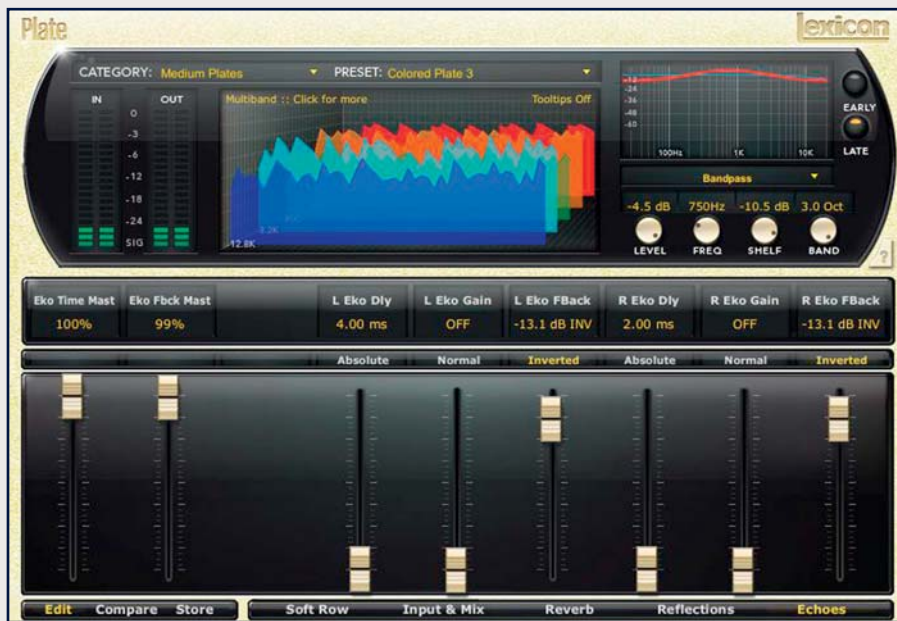
Das Feedback der Echos kann normal aber auch invertiert werden, um interessante Raum-Effekte zu erzeugen.
