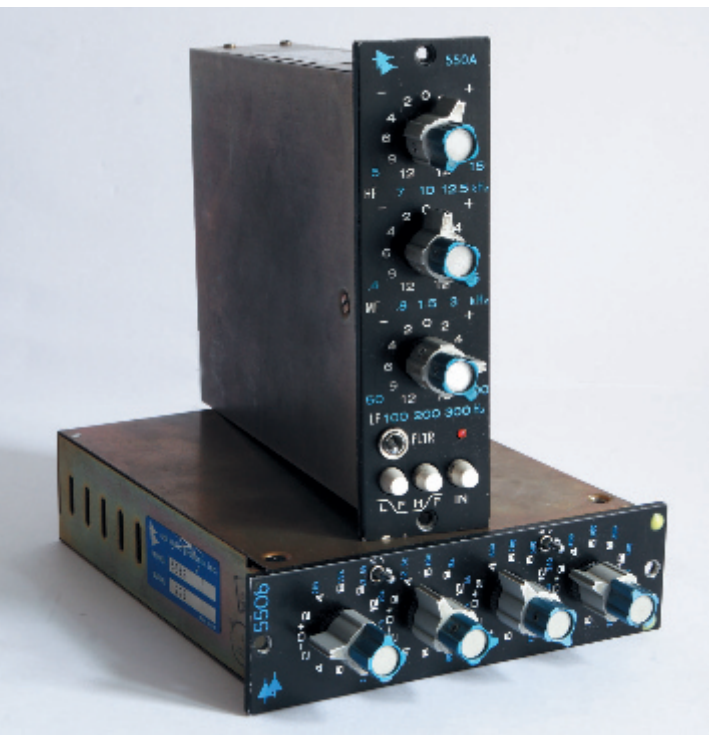
Kompakte Kassetten: Das 500-Format hat sich mittlerweile als Standard etabliert, für den auch andere Hersteller Module anbieten.
