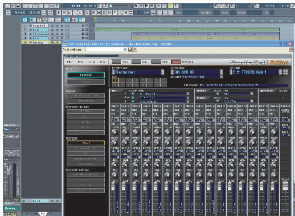
Über die Editor-Software lassen sich Parameter übersichtlich bearbeiten und der Signalweg sowie die Verteilung auf die Effekte bestimmen.
