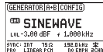
Das Display zum Festlegen der Parameter eines Sinussignals
