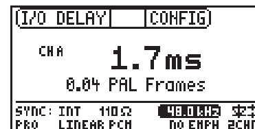
Abb. 6: Ergebnis einer Laufzeitmessung
