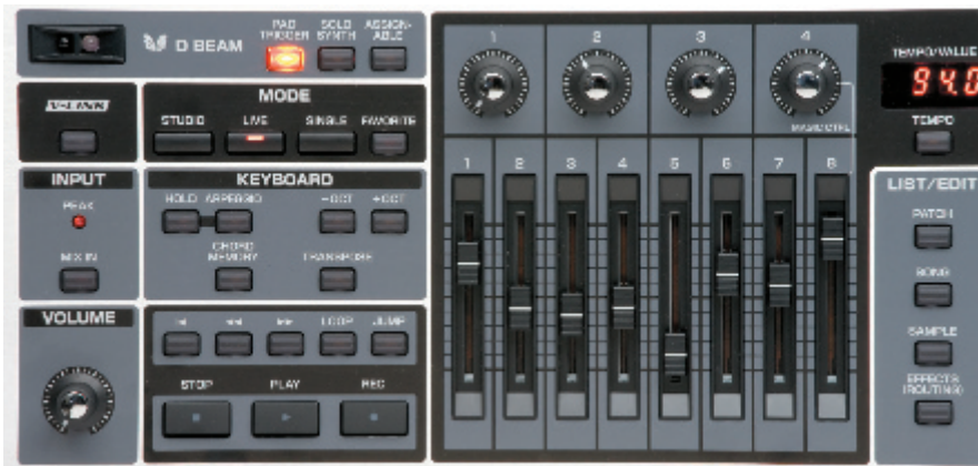
Üppige Ausstattung an Kontrollelementen: D-Beam, vier Knobs, acht Schieberegler, Sequenzer, Arpeggiator. Mit „Chord Memory“ kehrt eine beliebte Funktion vieler Vintage-Synthesizer zurück.
