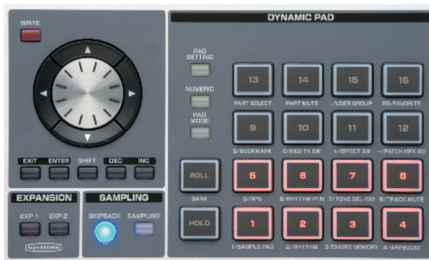
Mit den 16 Pads lassen sich nicht nur Samples abfeuern, sondern auch zuvor aufgezeichnete Real-Time-MIDI-Phrasen starten. Außerdem können die Pads zur Kontrolle der Tastatur-Parts dienen. Damit haben Sie die Livesituation im Handumdrehen organisiert.
