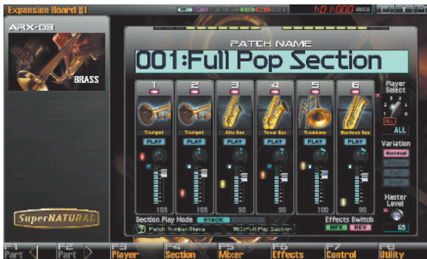
Die Klangerzeugung des ARX-03 Boards stellt dem Benutzer einer Fantom-G ein virtuelles Blechbläserensemble bereit, das während des Livespiels in Echtzeit realistische Bläsersätze erzeugt – die Lämpchen neben den Fader-Anzeigen symbolisieren die Notenverteilung.
