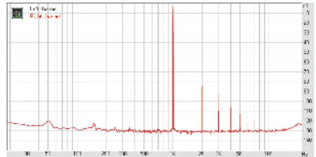
Bei voller Aussteuerung zeigt sich ein leicht erhöhter Klirr; bei etwas konservativerer Aussteuerung (-6 dBFS) ist der Klang sauberer.
