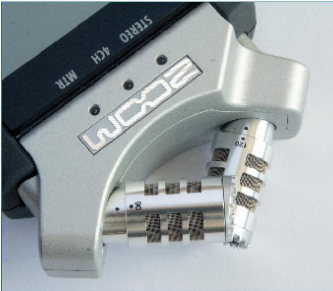
Durch Drehen der leicht schräg eingebauten Kapseln lässt sich der Aufnahmewinkel auf 90 oder 120 Grad justieren.
