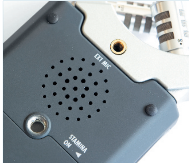
Auch der Rücken kann entzücken: Miniklinken-Anschluss für semiprofessionelle Mikros, ein kleiner Abhörlautsprecher und ein (Foto-)Stativgewinde aus Metall.
