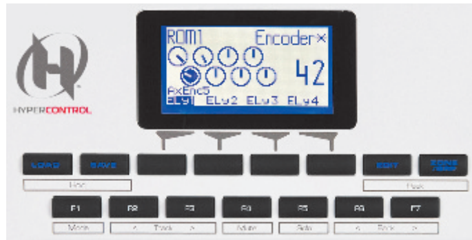
Auf 128 x 64 Flüssigkristallen ist der Status aller bewegten Bedienelemente abzulesen.
