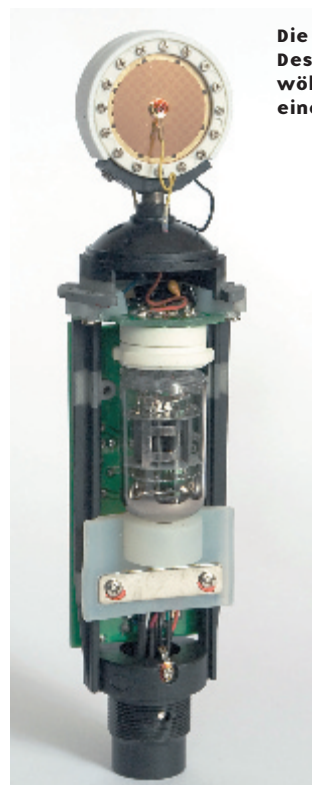
Die Platine des Perception 820 Tube: Saubere Verarbeitung hochwertiger Bauteile und ein gezielt leicht unterdimensionierter Übertrager.
