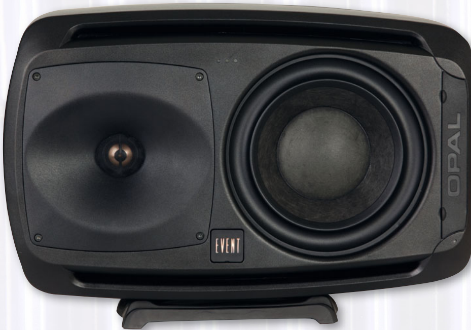
Der Waveguide um den Hochtöner des Opal lässt sich, nachdem die Torx-Schrauben gelöst sind, um 90 Grad drehen. Mit der mitgelieferten Gummianterlage lässt sich der Lautsprecher dann liegend betreiben
