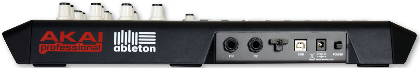
Der APC40 bietet rückseitig zwei Foot-Controller-Buchsen (6,35-mm-Klinke) um bestimmte Parameter sozusagen per pedes fernzusteuern.
