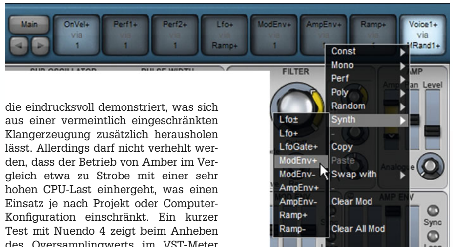
Die Transmod-Matrix erlaubt opulente Modulationsverknüpfungen. Je eine Quelle, die wiederum von einer anderen Quelle moduliert werden kann, lässt sich in einen Slot laden. Beliebig viele Verknüpfungen mit Adressen erfolgt durch simples Bewegen der Bedienelemente, mit der sich gleichzeitig die Modulations-Intensität einstellen lässt.
