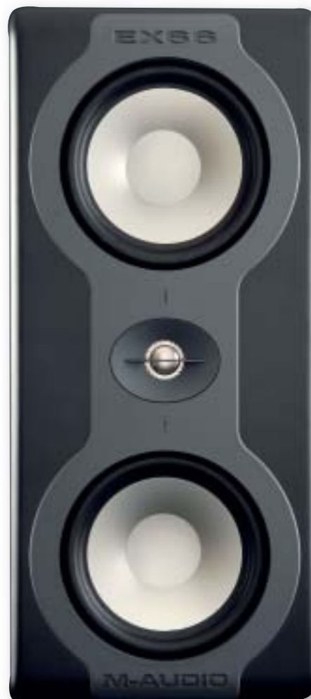
Der EX66 hat drei Lautsprecherchassis, die nach dem D'Appolito-Prinzip angeordnet sind. Dies begünstigt theoretisch wegen der systembedingten engeren, vertikalen Bündelung die räumliche Auflösung.
